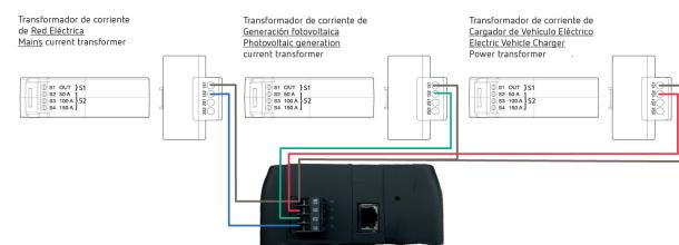
Nota: La conexión que se muestra en este esquema utiliza una relación de transformación de escala 50 A, por lo tanto, este es el valor que deberá indicarse en los parámetros de configuración.
