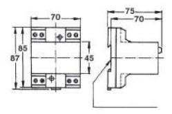
DIN 46277 (EN 50022) FIJACIÓN / FIXING
