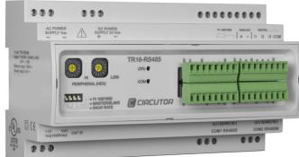
TRH16-RS485, 16 canais configuráveis 25/100/200 A Medida de tensão de 1500 Vcc 3 entradas digitais livres de tensão 1 Entrada para sonda PT100/PT1000 1 Entrada 0...20 mA,
