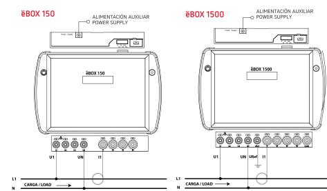
Conexión de la corriente de fuga, IL leak
