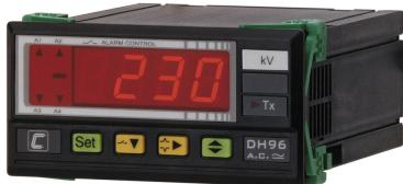
DH96CPM, Multímetro para medida en continua
