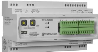
TRH16-RS485, 16 canales configurables 25/100/200 A Medida de tensión de 1500 Vcc 3 Entradas digitales libres de tensión 1 Entrada para sonda PT100/PT1000 1 Entrada 0...20 mA,
