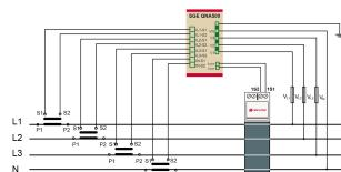
Conexión tensión directa y 4 TI's + trafo WG
