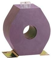
TRP40 200/5A 5P20, Transformateur de protection, capsulés en résine, diamètre 40 mm
