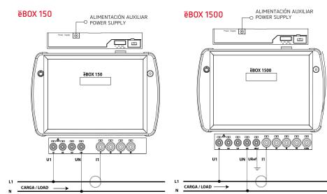
Conexión de la corriente de fuga, IL leak
