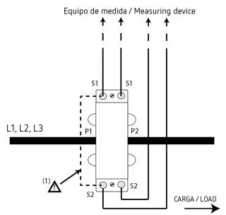
(1) Una vez cableado el secundario del transformador (S1 y S2) al equipo de medida, eliminar el puente realizado entre los secundarios de tensión /
