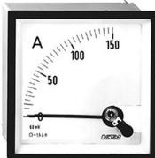
BC72 .../60mV, Ampèremètre pour mesure en courant continu, bobine mobile, panneau 72x72
