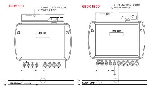
Conexión de la corriente de fuga, ILeak
