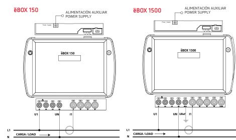
Conexión de la corriente de fuga, ILeak
