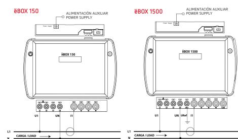
Conexión de la corriente de fuga, ILeak
