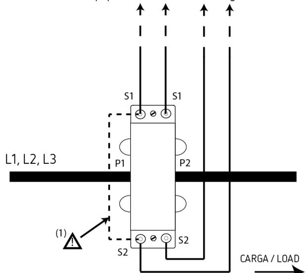
(1) Una vez cableado el secundario del transformador (S1 y S2) al equipo de medida, eliminar el puente realizado entre los secundarios de tensión /
