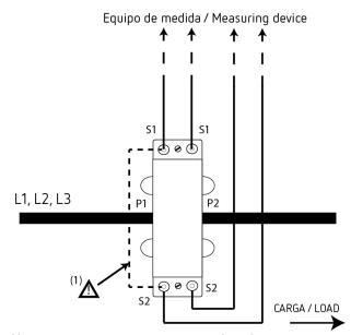
(1) Una vez cableado el secundario del transformador (S1 y S2) al equipo de medida, eliminar el puente realizado entre los secundarios de tensión / Once the secondary of the transformer (S1 and S2) is wired to the measuring device, disconnect the jumper installed between the secondary current.
