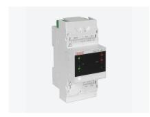
Line-M-4IO-T, Módulo de expansión de 4 entradas digitales y 4 salidas digitales de transistor.
