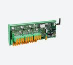
STM-S-24-F915, Equipo medida shunt, 24 entradas, comunicaciones LoRa frecuencia 915 MHz
