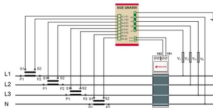
Conexión tensión directa y 4 TI's + trafo WG
