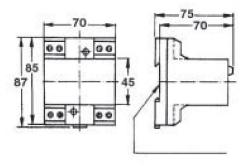
DIN 46277 (EN 50022) FIJACIÓN / FIXING
