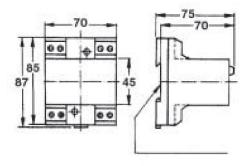
DIN 46277 (EN 50022) FIJACIÓN / FIXING
