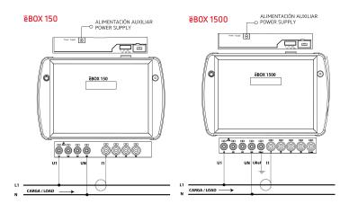
Conexión de la corriente de fuga, lLeak Leakage current connection, ILeak
