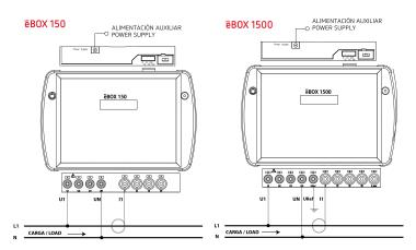
Conexión de la corriente de fuga, lLeak Leakage current connection, ILeak
