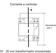
WI/...30 con transformador incorporado
