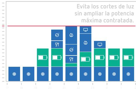
Compatible con el sensor **CirBEON**, que combinado con la **eNext** ajusta de forma dinámica el consumo del vehículo eléctrico teniendo en cuenta la potencia disponible en la instalación.
