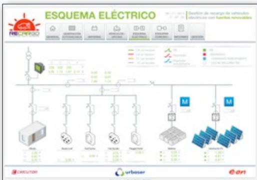
L'écran « Schéma électrique » prétendait montrer un schéma unifilaire de l'installation, et connaître les paramètres électriques principaux. De plus, il offrait la possibilité de voir et d'agir sur les protections qui le permettraient.
