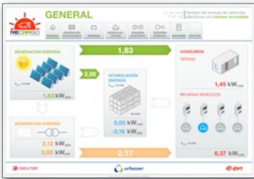
Der Hauptbildschirm der PowerStudio SCADA-Software dient dazu, das Blockschaltbild des Systems und den Status der Leitungen und Geräte anzuzeigen.
