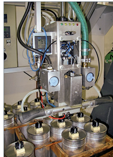
Proces napełniania i uszczelniania kondensatorów
