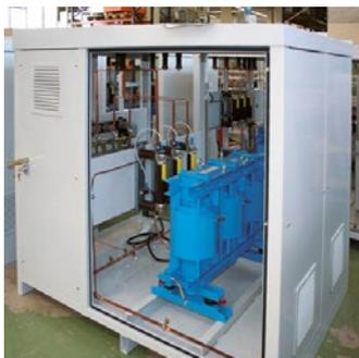
Ampla gama de reactâncias tanto monofásicas como trifásicas para fabricar filtros de harmónicas sintonizados, podendo ser produzidos a diferentes tensões, desde 1 kV até 36 kV, e qualquer frequência de sintonia 5,67%, 6%, 7%, 14%, etc.
